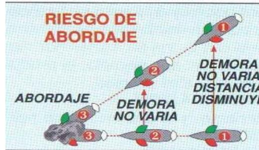
b) Si se dispone de equipo radar y funciona correctamente, se utilizará en forma adecuada, incluyendo la exploración a gran distancia para tener pronto conocimiento del riesgo de abordaje, así como el punteo radar u otra forma análoga de observación sistemática de los objetos detectados.
